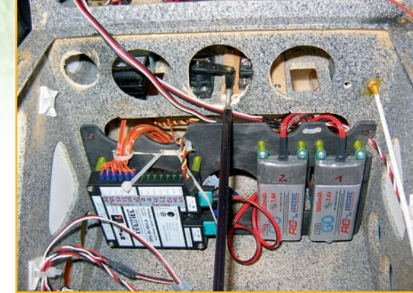
Mit Zündungs- und Anlasserakku sind mitunter glatt vier Stromquellen an Bord.
