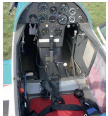
Das übersichtliche Cockpit der D-KJNN mit den analogen Rundinstrumenten
