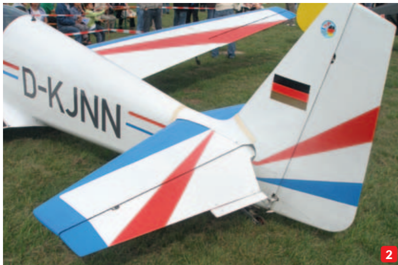
Die Tragfläche hat eine mit Sperrholz beplankte Nase, hinter dem Holm ist die Fläche Stoffbespannt (1). Auch die schicke D-KJNN haben wir in einer farbigen Dreiseitenansicht-Zeichnung dargestellt. Hier ein Blick auf das Leitwerk mit der Höhenruder-Trimmklappe links (2). Das Spornrad ist gefedert und über Federn mit dem Seitenruder gekoppelt (3). Unter jeder Fläche sorgt ein kleines Rad an einer GFK-Stange dafür, dass die Maschine einigermaßen waagrecht auf der Piste steht (4)
