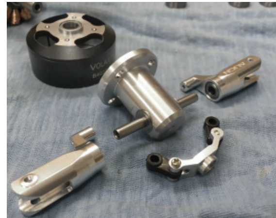
Dieser Verstell-Propeller mit innenliegender Anlenkung basiert auf Heckrotorteilen eines 500er Helis.
