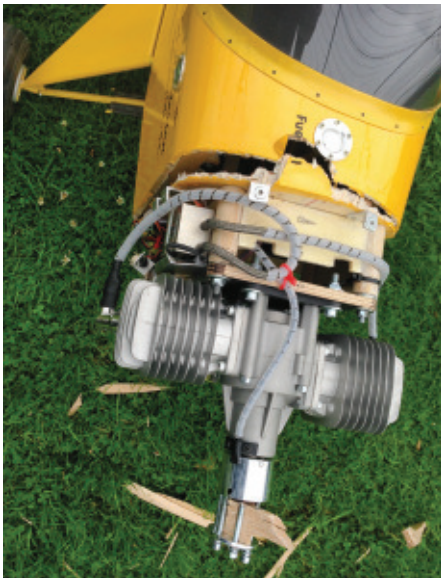
Abb. 4: Die Folgen einer losen Propellerbefestigung zeigen die enormen Kräfte, verursacht durch die Drehmomentstöße eines Benziners.
