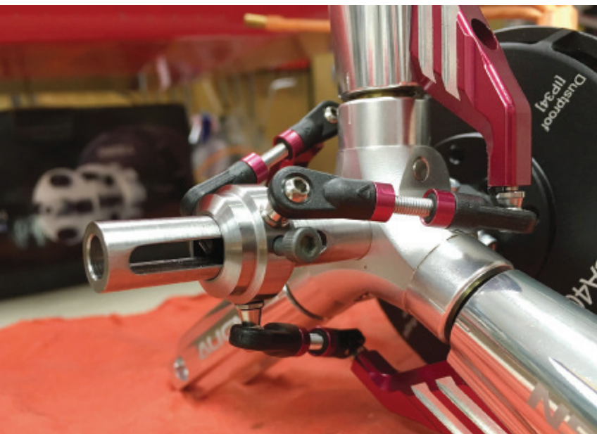
Für die große Verstell-Mechanik verwendete Christian Grogg Bauteile eines Dreiblatt-Rotorkopfes.
