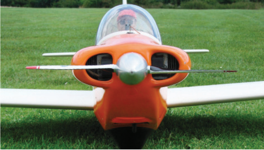
In Segelstellung verursacht der Propeller den geringstmöglichen Widerstand.
