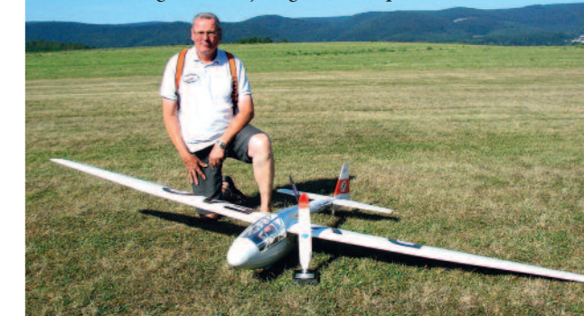
Stolz und glücklich: Jürgen Krüger erhielt für den Eigenbau seiner Chemnitz C-10 mit der Umlauf-Luftschraube im Leitwerksträger den diesjährigen Technikpokal.
