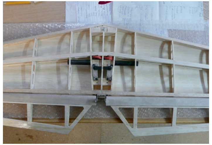
01 | Der Flügelbau vor dem Beplanken der Unterseite, eingelegt in der Helling 02 | Das Höhenleitwerk vor dem Beplanken. Die Servos sind im Mittelteil eingebaut
