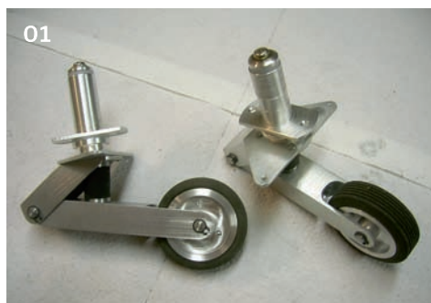
01 | Auch die Heckspornfahrwerke wurden aus dem Vollen gefräst 02+03 | Die mehrlagig aufgebauten Armaturenbretter, wie im Text beschrieben
