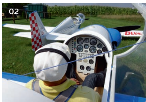
01 | Auch die Heckspornfahrwerke wurden aus dem Vollen gefräst 02+03 | Die mehrlagig aufgebauten Armaturenbretter, wie im Text beschrieben
