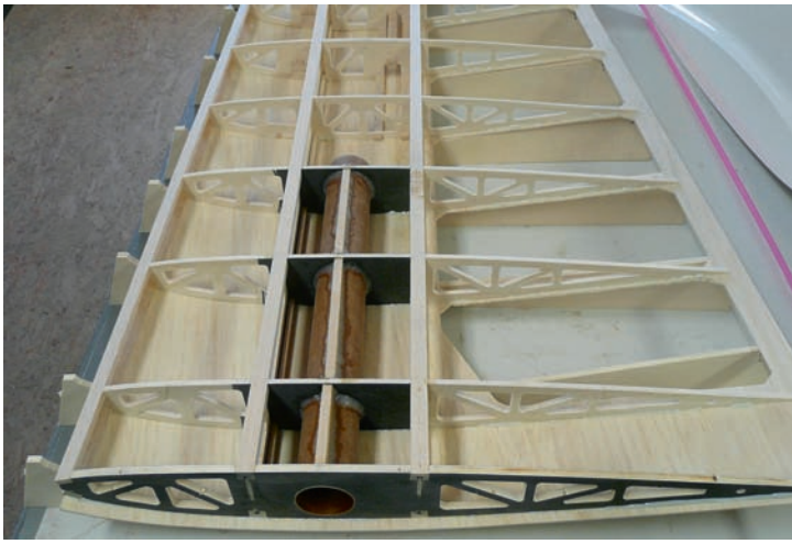
01 | Der Flügelbau vor dem Beplanken der Unterseite, eingelegt in der Helling 02 | Das Höhenleitwerk vor dem Beplanken. Die Servos sind im Mittelteil eingebaut
