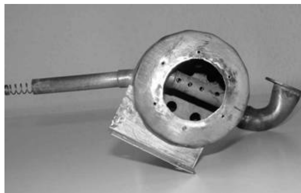
Mit einer kleinen Bürste ist das Innere des Topfes gereinigt worden. Mit der Druckfeder wurde das Abgasrohr von innen gereinigt.
