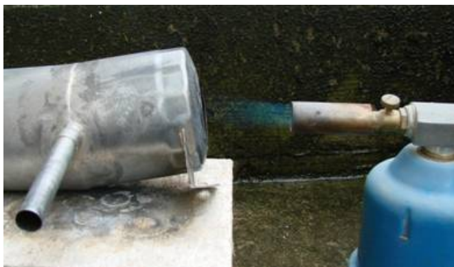
Die Flamme kann so tief in das Innere des Topfes gelangen und der Ruß kann verbrennen.
